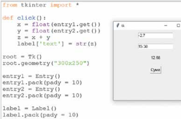
Мал. 4.15. Вікно з двома полями, написом і кнопкою та текст проєкту з процедурою для додавання двох чисел
